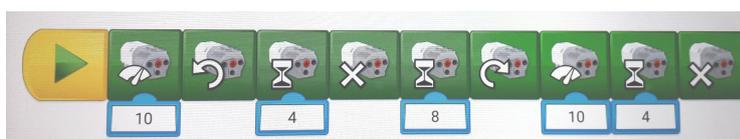
Работа программы начинается с нажатия блока «Начало». Мощность среднего мотора установлена 10. он будет вращаться 4 секунды в одну сторону. Через зубчатую передачу ось с колесами начнет вращаться и машину приведет в движение вперед. Через 4 сек. мотор остановится на 5 сек. Затем мотор будет вращаться 4 сек. в другую сторону., и мотор остановится.
