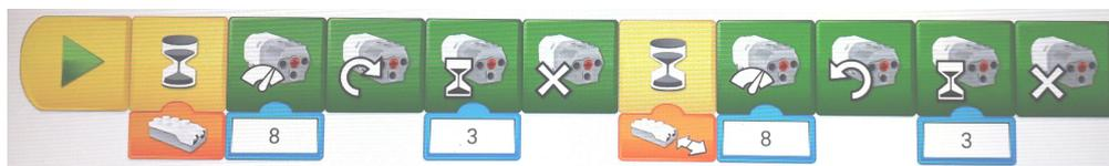
Мы запрограммировали дверь так, что средний мотор начинает вращаться 3 секунды и открывается дверь сама, когда датчик расстояния видит машину (которая везет пюре в сушилку). После мотор останавливается. Тут же, когда машина выезжает из сушилки, датчик расстояния видит машину и средний мотор начинает вращаться в другую сторону 3 секунды, дверь закрывается и мотор останавливается .
