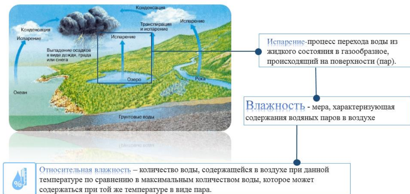
Рисунок 3 – Процесс испарения воды с поверхности и формирование влажности
