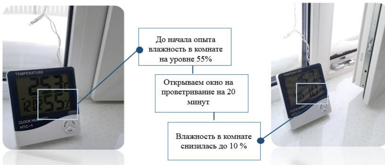
Рисунок 8 – Опыт «Можно ли повысить влажность воздуха в комнате с помощью проветривания?»
