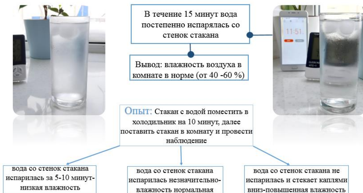
Рисунок 11 – Определение влажности воздуха без специального оборудования
