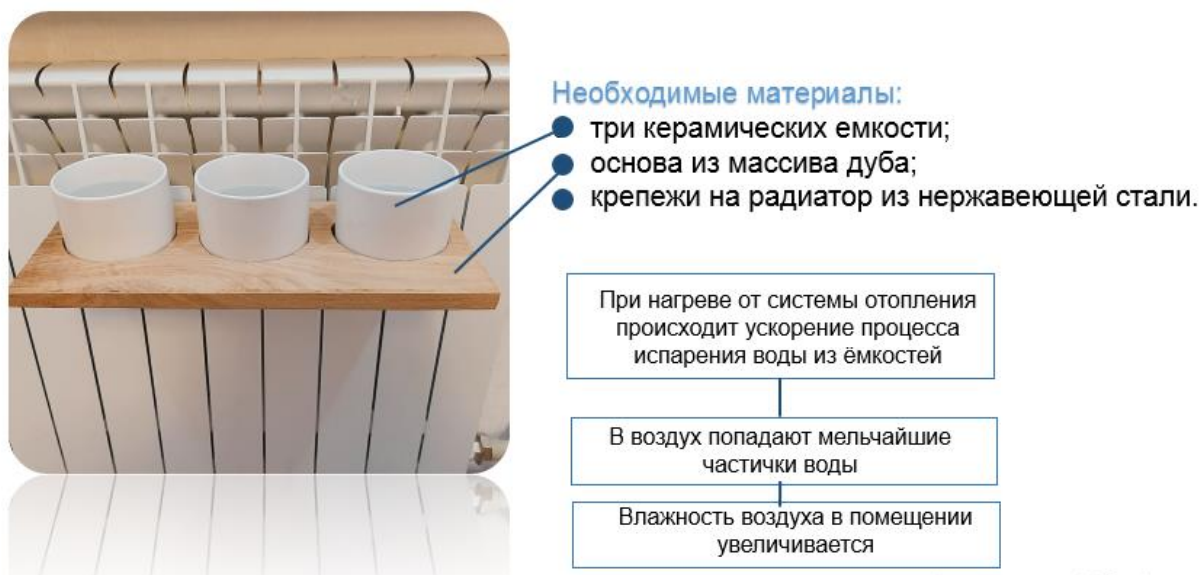
Рисунок 13 – Разработка увлажнителя воздуха для помещения.
